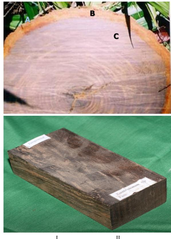
**Gambar 1.** I. Kayu Sowang: (A) bagian kulit kayu; (B) bagian kayu gubal; (C) bagian kayu teras. II. Bagian teras kayu sowang (Gunawan et al., 2018)
