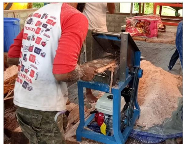
**Gambar 2.** Proses Pamarutan Empulur Batang Sagu Menggunakan Mesin Parut Sagu Tipe Silinder Varian-02
