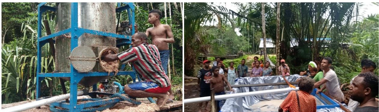
**Gambar 3.** Proses Ekstraksi Pati Menggunakan Mesin Ekstraksi Pati Tipe *Vertical Stirrer Rotary Blade*
